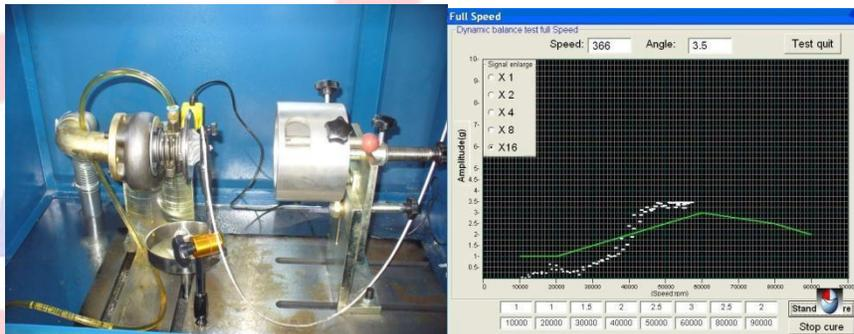
NT-D3 máquina de balanceo general de velocidad completa está completamente automatizada, elimina las diferencias debidas al operador manual. Entonces, los resultados de las pruebas son más repetibles y compatibles.
